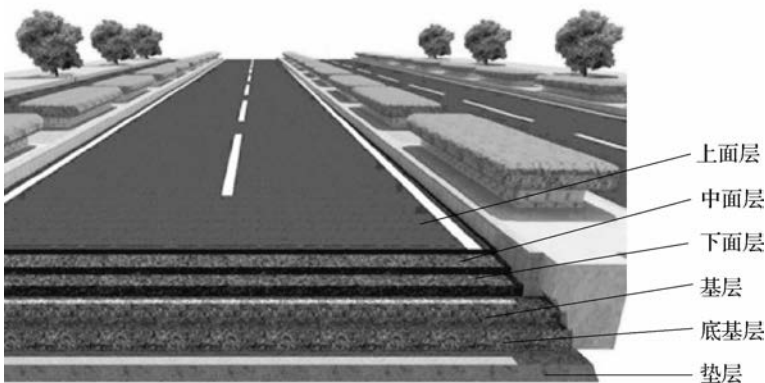
图 1-10 路面的结构组成
