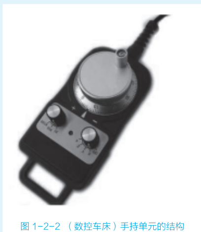
图 1-2-2 (数控车床) 手持单元的结构
